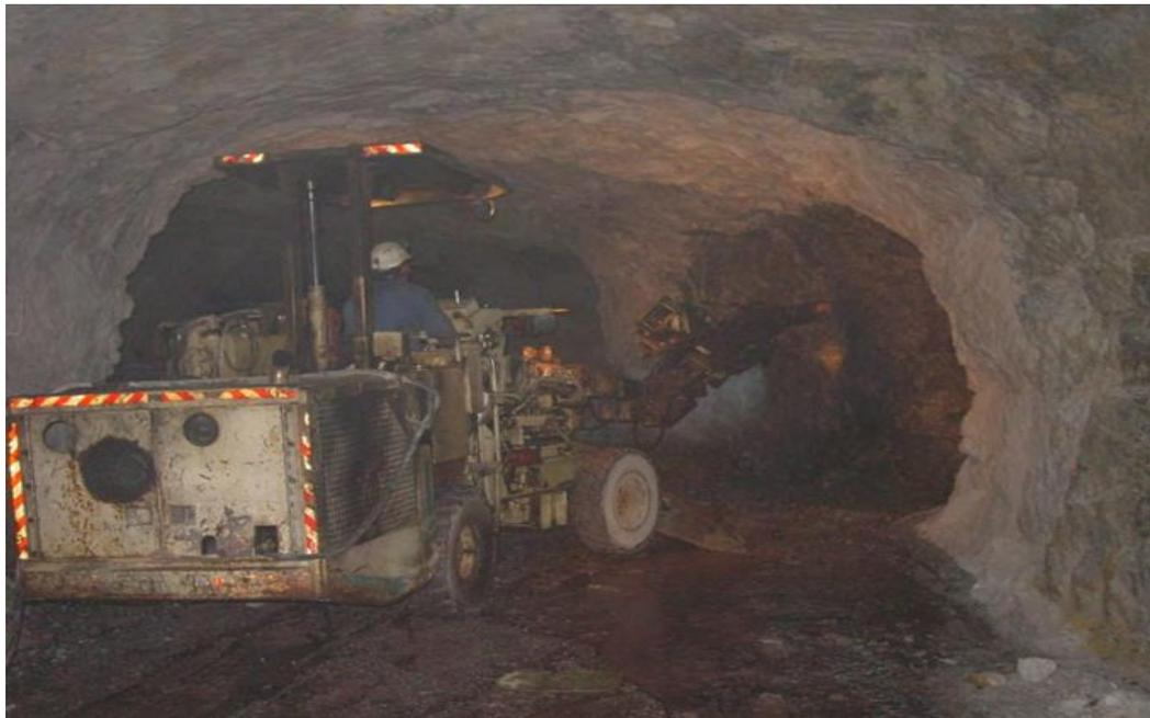
**FIGURE 16.3**      **LOAD HAUL DUMP UNIT**
